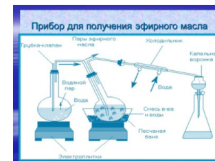
1-сурет – Эфир майларын су буымен айдау арқылы алу құрылғысының сызбасы
